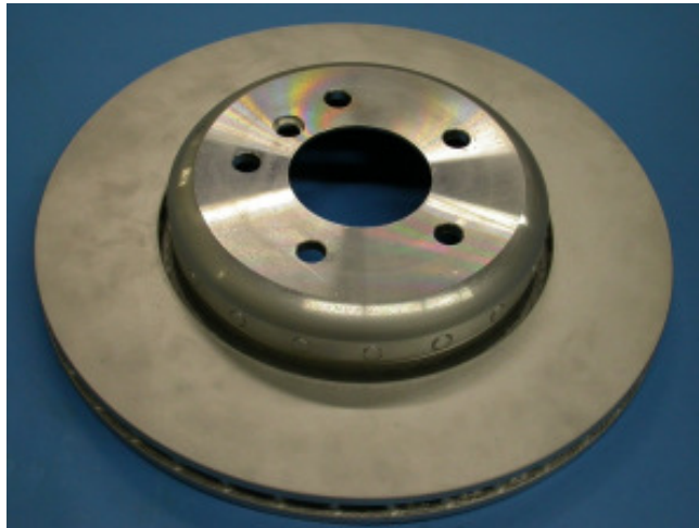
Bild 12: Leichtbaubremsscheibe mit Graugussreibring und Aluminiuminnentopf
