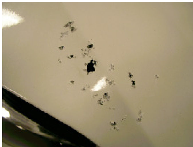
Bild 10: Steinschläge auf einer Magnesiumaußenhaut führen innerhalb einiger Monate zur „Durchrostung“
