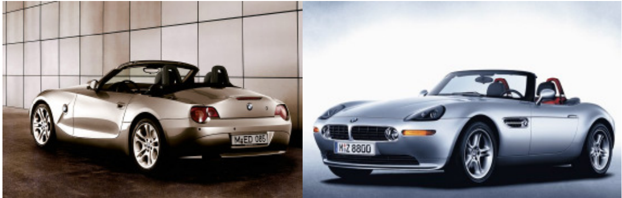
Bild 11: Außenhautdesign mit Stahl (BMW Z4, links) und Aluminium (BMW Z8, rechts)
