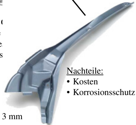
Bild 20: Verstärkung A-Säule beim BMW 3er Cabrio aus warm umgeformtem BTR165
